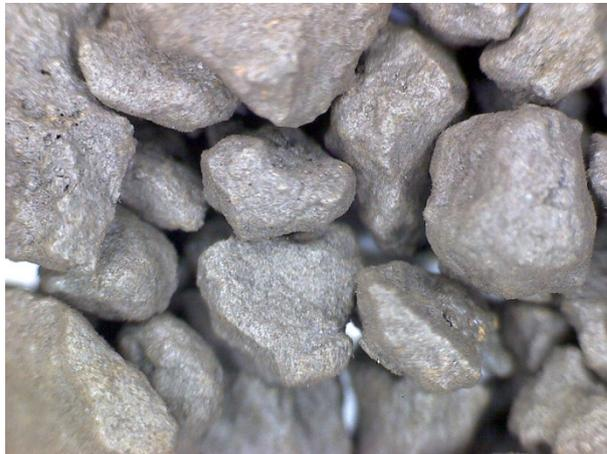
Stirox применяется как классическая фильтрующая загрузка, работающая как с окислителем, так и как каталитическая среда ускоряющая реакцию окисления.
