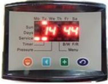
**Pressure** (Давление) – индикация выбора режима регенерации при падения давления (Р7 = 3 или 4).
