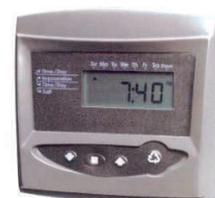
**Logix 740 (time clock)** – простой временной контроллер с возможностью установки регенерации/промывки с периодичностью от 2-х раз в сутки до 99-ти дней. Может использоваться как в установках умягчения, так и фильтрах (с функцией регулирования длительности обратной промывки). Этот контроллер наиболее подходит для бытовых и малых промышленных установок с объемом загрузки до 85 л.
