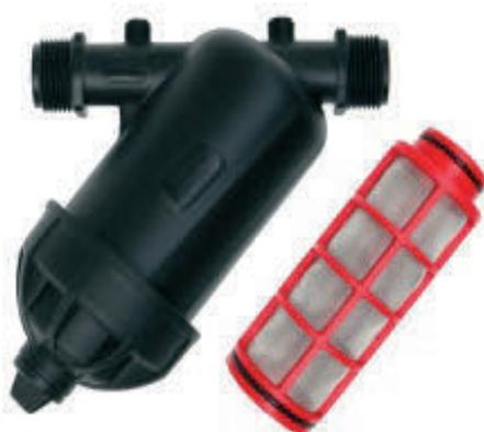
Фильтр произведен из полипропиленового конструкционного пластика; его легко монтировать, он обладает высоким сопротивлением к сжатию, повышенной износостойкостью; задерживает частицы материалов и примесей, использование сетчатого фильтра позволяет облегчить процесс и ускорить время очистки, обеспечивая при этом экономию водных ресурсов. Долговечен. Размер пор сетчатого картриджа - 120 микрон.
