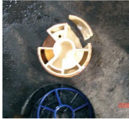
Недостатком данного типа клапанов можно назвать весьма скорое нарушение уплотнения между дисками, в случае присутствия в фильтруемой воде повышенного содержания абразивных веществ: мелкодисперсного песка, глины, осадочные породы. Кальматация окисленного железа также может привести к выходу из строя клапана управления.
