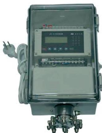
**Электронный блок** предназначен для управления установкой очистки воды с использованием электронного микропроцессора и импульсного расходомера (опционально). Он обеспечивает возможности гибкого управления режимами работы фильтра. Функциональные возможности контроллера включают в себя: программируемые циклы, интервал между регенерациями, ручная регенерация, дистанционное управление регенерацией, автоматическая регенерация, **«бизнес функция»** - отключение контроллера через
