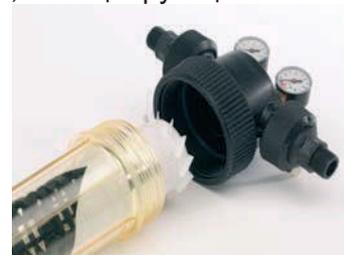
Концепция **CINTROPUR®** основана на двойном принципе. На входе поток воды под давлением попадает на турбину, расположенную в головной части фильтра. За счёт этого образуется завихрение, направленное вниз, благодаря которому, все крупные частицы, взвешенные в воде, оседают на дне стакана. Вторым этапом является удержание оставшихся более мелких частиц, фильтровальным мешком, выбор которого поможет гарантировать качество очистки в зависимости от выбранного уровня фильтрации.
