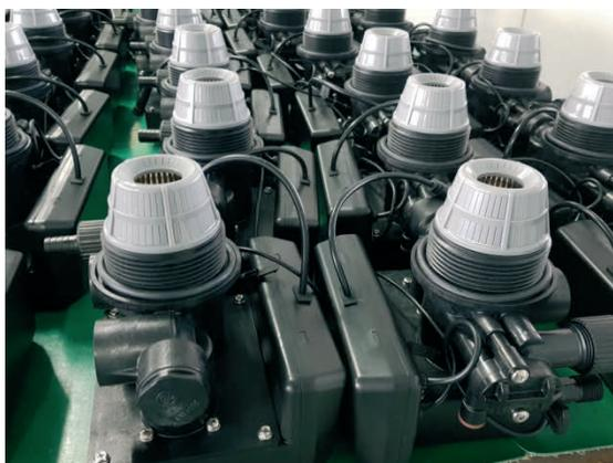
В кабинетах данной серии используется специально разработанный клапан управления с отдельно вынесенным контроллером, размещенным на крышке корпуса. Соединение контроллера с клапаном производится через разъемный коммутирующий провод.
