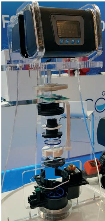
В конструкции блоков управления **RUNXIN** использован дисковый принцип регулировки потоков воды при помощи двух дисков, один из которых - неподвижный, другой – подвижный (вращающийся). Оба диска имеют в своей конструкции сегментарные полости. Подвижный диск вращается относительно неподвижного, совмещая полости или перекрывая их. В качестве материала дисков используется керамика, обеспечивающая достойное качество уплотнения (наподобие современного сантехнического смесителя).
