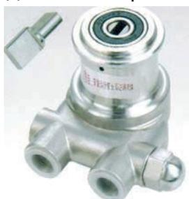
**Пластинчатый насос**, разновидность объёмного роторного насоса, рабочими органами которого являются ротор, вращающийся в эксцентрично расточенном статоре, и пластинки, вставленные в продольные пазы ротора и прижимаемые к статору центробежной силой, пружинами или давлением жидкости, подводимой со стороны оси ротора.
