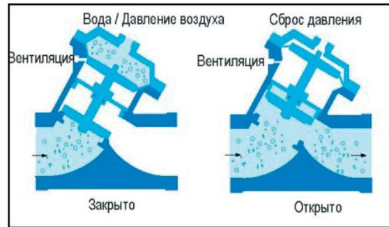
**Опционально** диафрагменные клапаны могут дополняться следующими функциями:
