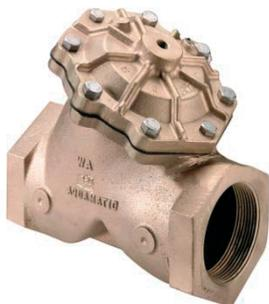
Клапаны серии **V46** изготовлены из сплава на основе нержавеющей стали. Конструкция и материал уплотнения (нитрил) позволяют использовать клапан при давлении 17 бар и температуре 120 °С. Типоразмеры: 1", 1 ½", 2". Область применения: системы обратного осмоса; фильтры для морской воды; стерилизация паром; пищевая, бумаго- и мясоперерабатывающая промышленность; генераторы озона.
