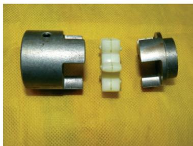
**Соединительная муфта** предназначена для передачи вращающейся силы от вала электродвигателя к валу насоса.
