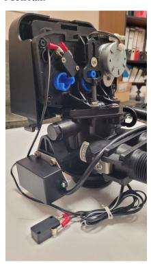
Микропереключатель крепится при помощи входящих в комплектацию саморезов на заднейпанеле клапана управления в специально предусмотренном для него месте.
